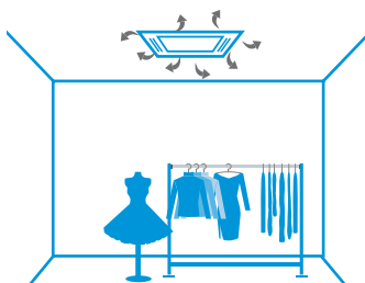
Distribuzione dell'aria con filtro sporco
